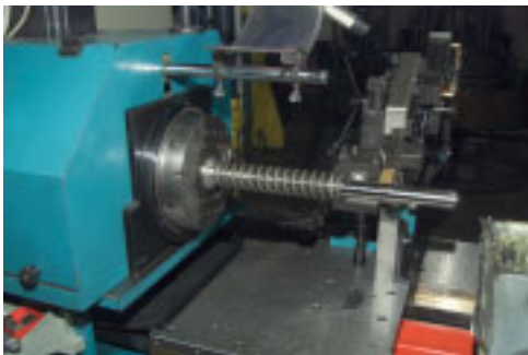
Wickelmaschinen – Unter Verwendung der neuesten Entwicklungen der CNC-Wickeltechnologie werden Federn mit einer weit besseren Vorhersagbarkeit und Konsistenz in Bezug auf Leistung, Federkraft und Längen hergestellt.
